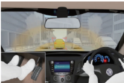
図表8. ASVにおける 衝突被害軽減ブレーキ(出典8)
